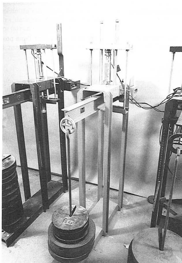
Photo 4 : bâti de fluage, réalisé à partir d'un bâti oedométrique.
