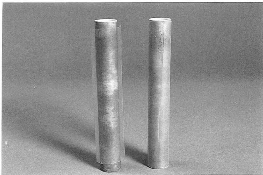
Photo 3 : vue du moule en téflon retenu pour les essais.. Une gaine thermorétractable est placée autour du moule pour rendre la partie fendue étanche (à gauche avant chauffage, et à droite après chauffage).
