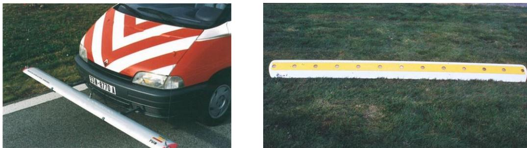
Figure 6. Vue du TUS (Transversoprofilomètre à ultrasons) utilisé en France
