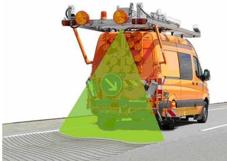
Figure 8. Illustration du principe de mesure par télémétrie laser à balayage (scanner)
