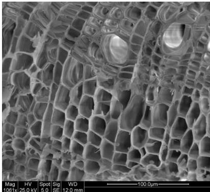
*Microstructure poreuse d'un granulat de chanvre*
