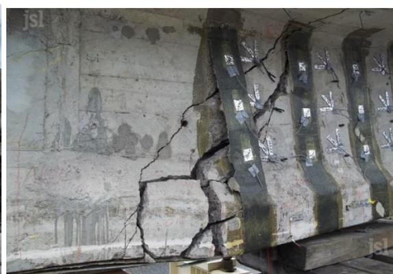
Expérimentation sur la poutre de Clerval - Essai de chargement à l'effort tranchant du 30 juin 2016
