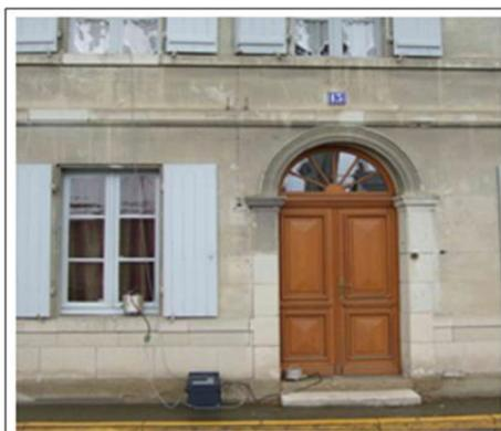
Fig. 1 : instrumentation d'une habitation soumise à des vibrations provoquées par la circulation routière
