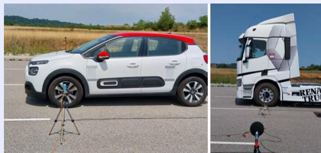
Mesure du bruit routier sur un véhicule léger et un poids lourd à l'arrêt (projet MINOOS)
