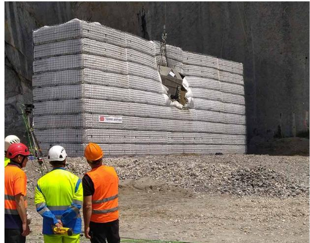
*Essai de validation de la conception des renforcements géosynthétiques d'un merlon de faible emprise au sol et de forte capacité de protection contre les chutes de blocs rocheux (ici : interception d'un bloc de 12,5 tonnes à 100 km/h)
