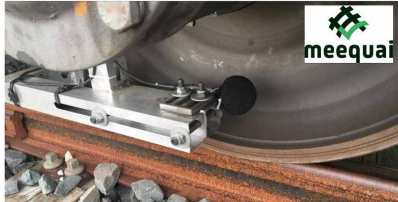
*Microphone embarqué pour la mesure indirecte de rugosité des rails*
