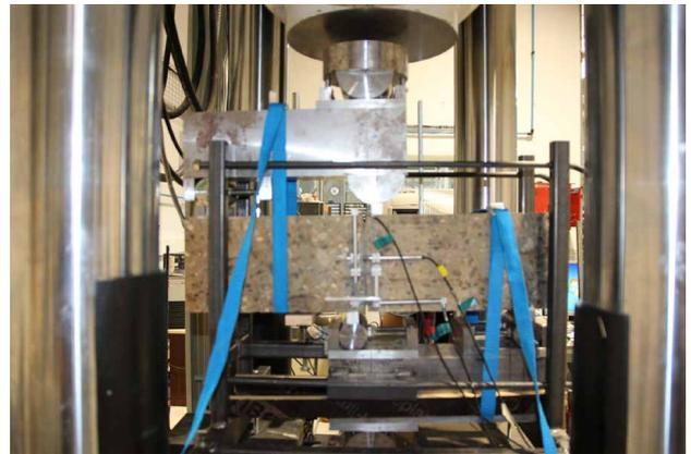
*Essai de cisaillement d'un prisme en béton de fibres, destiné à valider les lois de comportement.*
