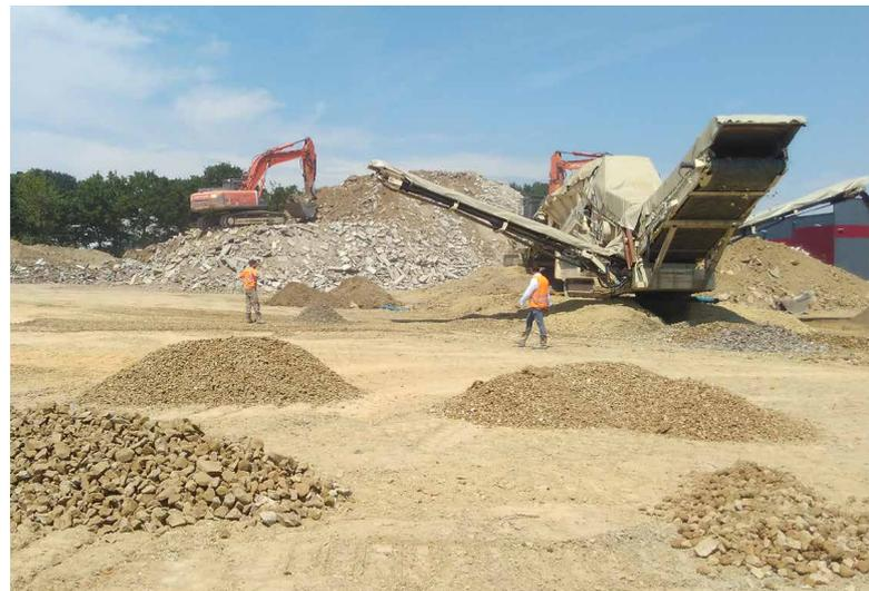
Appareil de tri innovant sur plateforme de recyclage
