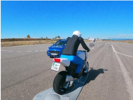
Essais d'une fonction d'aide à la conduite sur la piste Highway
